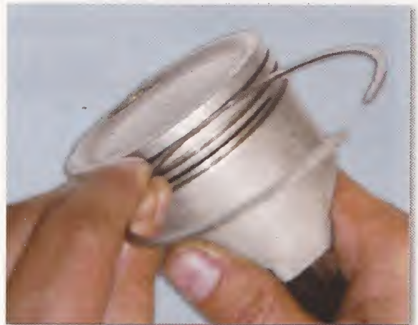
Verificación de la tolerancia anillos - ranuras
